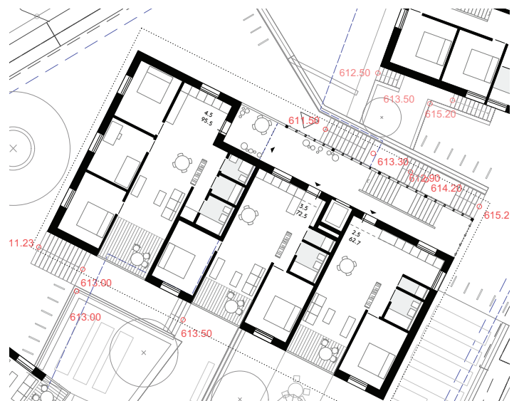
Durchwöhnen | Küche als Eingang und Filter gegen der Laubengang. Laubengang als Aussenraum.
